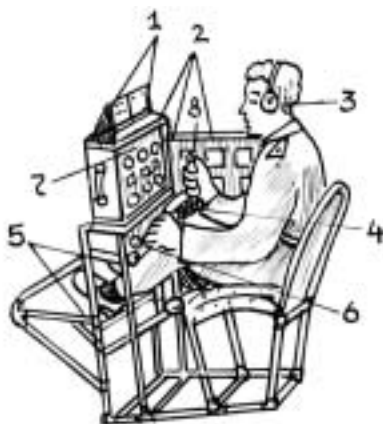
7 pav. Dėmesio ir judesių koordinacijos bei tempo tyrimo aparatas
